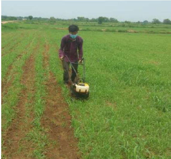
चित्र: विकसित शक्ति चालित निराई यंत्र का ज्वार चारा फसल में परीक्षण
