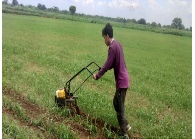
चित्र: विकसित शक्ति चालित निराई यंत्र का ज्वार चारा फसल में परीक्षण
